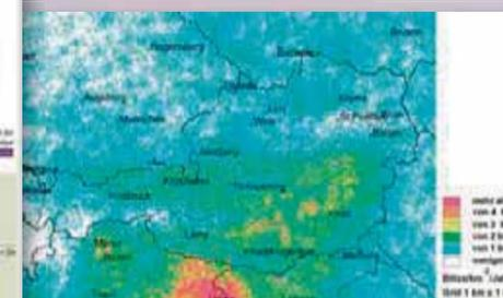
El valor de la densidad de rayos a tierra es importante para la realización de un análisis de riesgos de conformidad con la norma EN 62305-2\*, por eso, este parámetro se puede seleccionar fácilmente en la gestión de clientes/proyecto.
