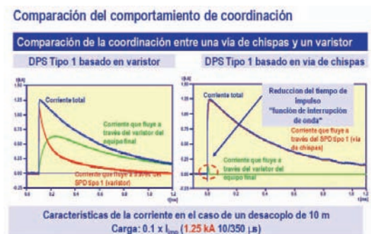
Figura 13. Comparación del comportamiento de coordinación entre una vía de chispas y un varistor
