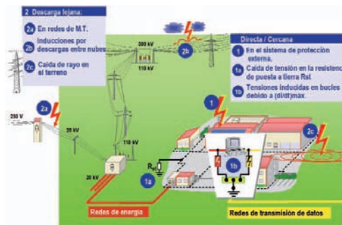
Figura 1. Causas de las sobretensiones.
