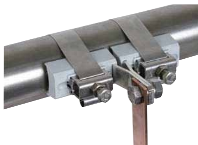
Ex-BRS 90 Parte No. 540 801 Rango de sujeción \varnothing 26.9 (3/4") - 88.9 mm (3") Ex-BRS 300 Parte No. 540 803 Rango de sujeción \varnothing 88.9 (3") - 300 mm Ex-BRS 500 Parte No. 540 805 Rango de sujeción \varnothing 300 - 500 mm
