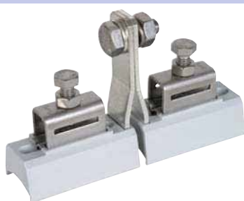
Cuerpo del sujetador separado Parte No. 540 810 Rango de sujeción \varnothing 26.9 (3/4") - 500 mm en combinación con la correa de tensión sin fin
