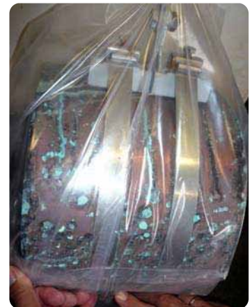
Figura 2 Resultado de la después de prueba envejecimiento artificial de acuerdo EN 50164-1 (VDE 0185-201)
